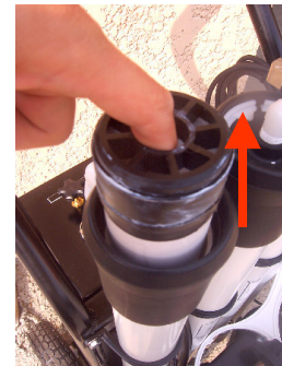
8 – Retirer doucement le filtre en repérant le sens
