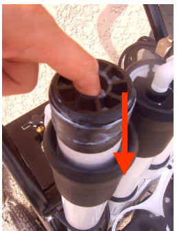
9 – Remettre le filtre neuf doucement dans le bon sens
