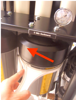
1 – A l'aide de la clé, dévisser les filtres
