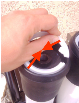
5 – Enlever la bague blanche en la serrant vers l'intérieur
