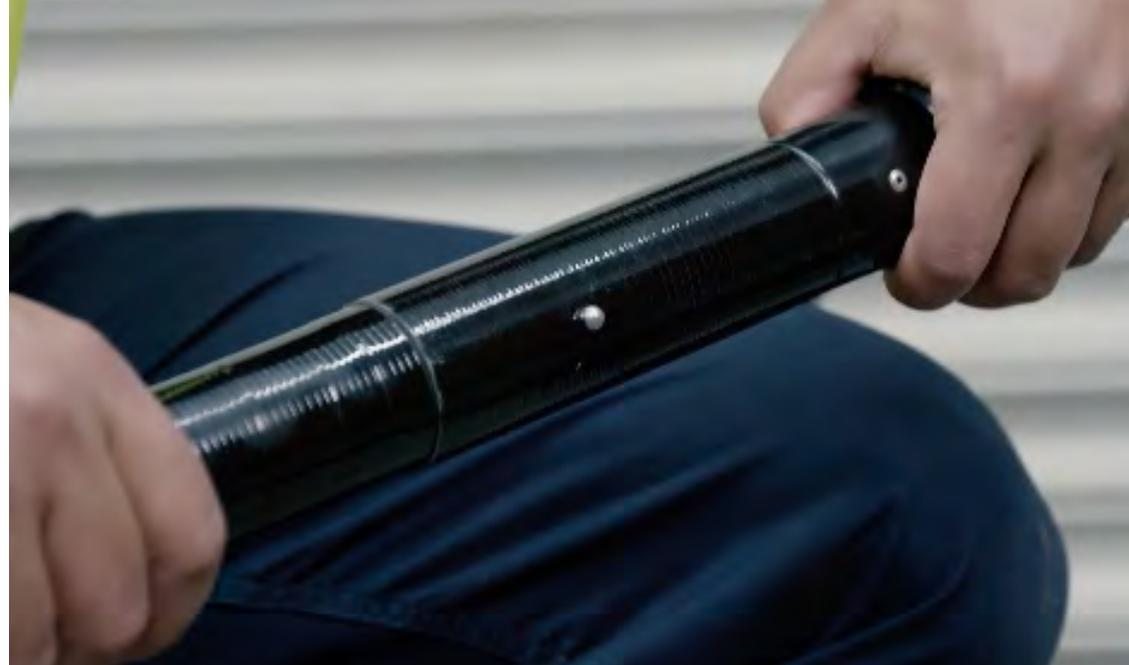
qui sont enlevés par l'air qui circule dans le système de vide (frottement contre les perches et les parois des tuyaux, etc.), des niveaux dangereusement élevés d'électricité statique peuvent s'accumuler sur le système de perches.
