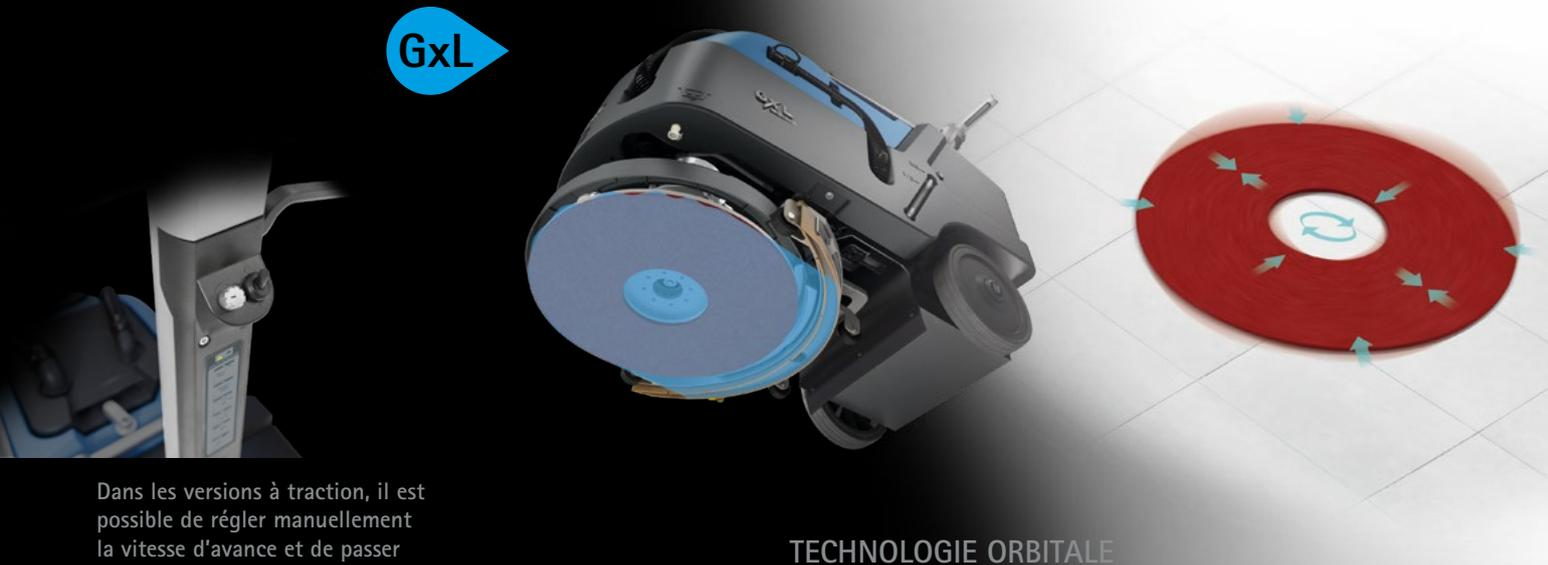
Dans les versions à traction, il est possible de régler manuellement la vitesse d'avance et de passer de la marche avant à la marche arrière à l'aide d'un levier.
