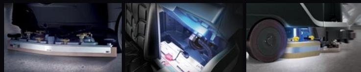
Le groupe de feux de service exclusif augmente la visibilité des parties pouvant être sujettes à des contrôles par l'opérateur, en éclairant les zones concernées avec des phares à LED
