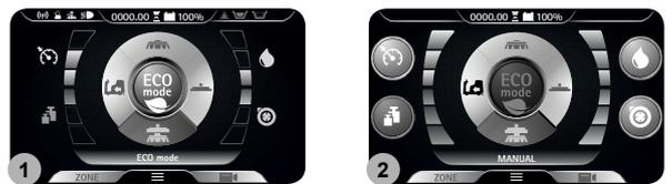
Le bouton ECO-MODE (1) se trouve au centre du sélecteur DS. Quel que soit le programme eco-mode, si l'on appuie sur le bouton (1), on passe de la modalité ECO à la modalité MANUAL, avec la gestion manuelle des différents paramètres.
