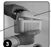
6. Nettoyer sous un jet d'eau courante le panier-filtre (2) et le couvercle du panier (3).
