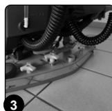
6. Nettoyer soigneusement au jet d'eau puis à l'aide d'un chiffon humide la chambre d'aspiration du corps du suceur.
