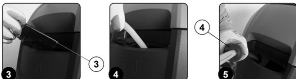
5. Remplir d'eau propre, à une température comprise non supérieure à 50 °C et non inférieure à 10 °C. Il est possible de voir la quantité présente dans le réservoir à l'aide du tube de niveau (5) (Fig. 6), placé à l'arrière gauche de la machine.
