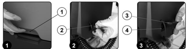
**AVERTISSEMENT** : Avant d'introduire le connecteur (3) dans la prise (4) vérifier l'absence de condensation ou d'autres types de liquides.
